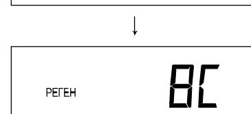
В зависимости от настроек клапана при получении внешнего сигнала на дисплее могут высвечиваться надписи «РЕГЕН» и поочередно надписи «ВС» и «ЗАПР». Более подробно смотри Шаг 5ОН.
