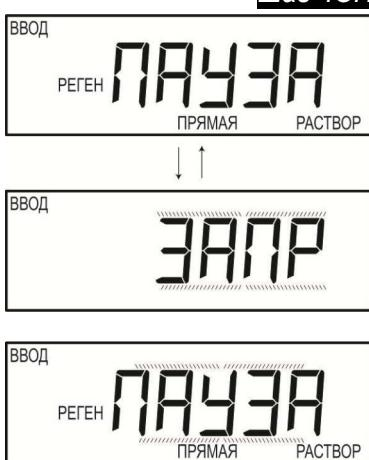
*Шаг 4ОН – Отложенное завершение промывки. Для клапанов WS1, WS1.25, WS2.1 и WS2.0L систем Twin Alternating.*
