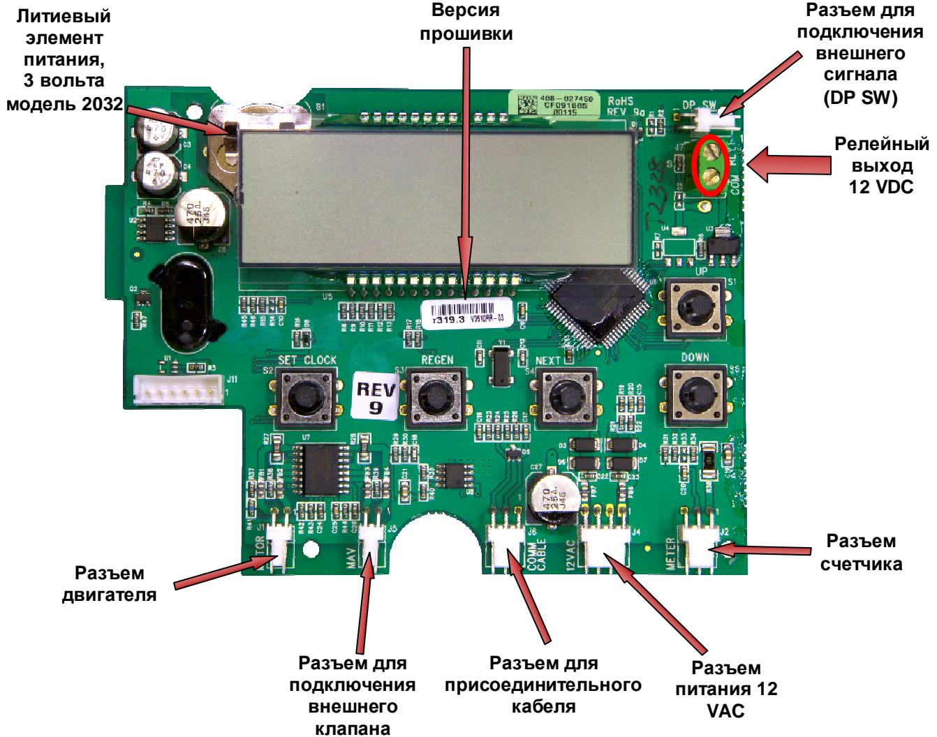
Примечание. Для создания систем «Twin Alternating» следует использовать только 3-жильный присоединительный кабель (арт. – V3474), независимо от количества используемых счетчиков.
