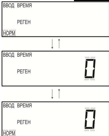
Шаг 10У – Установите параметр Режим регенерации, используя кнопки «ВНИЗ» или «ВВЕРХ» (на дисплее высвечиваются надписи «ВВОД», «ВРЕМЯ» и «РЕГЕН»):
