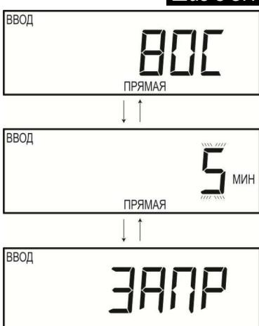
*Шаг 3'ОН – Только в случае настройки клапанов WS1TT и систем Twin Alternating с управляющим клапаном WS2. Установите продолжительность (в минутах) дополнительной прямой промывки, которая будет проводиться перед выходом в Сервис фильтра, который находился в режиме ожидания. Кнопками «ВВЕРХ» или «ВНИЗ» установите требуемую продолжительность дополнительной прямой промывки (1-20 минут) или отключите ее («ЗАПР»).*
