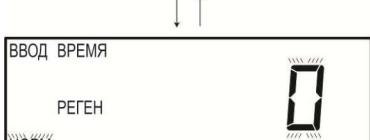
*Шаг 8Ф – Установите параметр Режим регенерации, используя кнопки «ВНИЗ» или «ВВЕРХ» (на дисплее высвечиваются надписи «ВВОД», «ВРЕМЯ» и «РЕГЕН»):*
